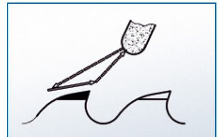
Schleifkopfbewegung bei Bi-Metall-Bändern
