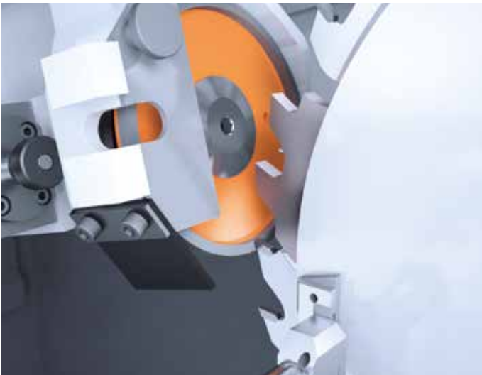
/// FREIFLÄCHENBEARBEITUNG an Spanersegment aus der Sägewerksindustrie
