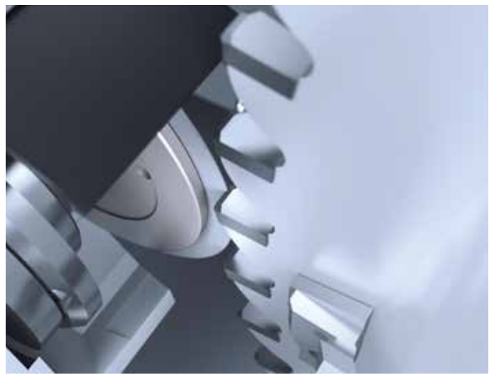
/// SPANTEILERBEARBEITUNG mit 125 mm Schleifscheibe
