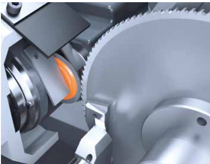
/// SPANTEILERBEARBEITUNG AN HSS-SÄGEN mit 50 mm Schleifscheibe
