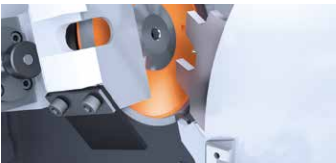
/// FREIFLÄCHENBEARBEITUNG an Spanersegment aus der Sägewerksindustrie
